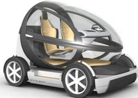
Le «So-On» est le concept visionnaire de Fritsch-Associés pour allier le design personnalisé à des coûts de production et de propriété moins élevés. Avec le concept modulaire de Fritsch-Associés, une partie importante du processus d'assemblage final est transférée du fabricant de matériel d'origine aux concessionnaires automobiles locaux.
