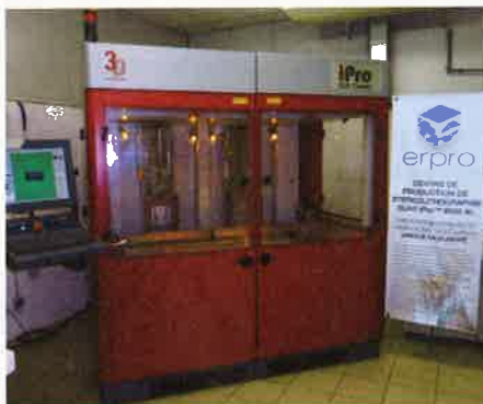
Machine de stéréolithographie iPro 9000 XL de 3D Systems. Erpro dispose de 4 machines de cette gamme dans son atelier.
