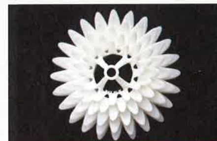
Très résistante, et offrant une belle coloration blanche, la résine Accura Xtreme White 200 constitue une alternative au PP et ABS usinés.
