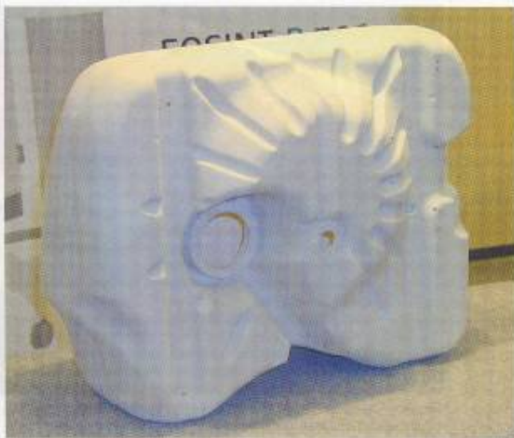
FKM Sintertechnik a fabriqué ce réservoir de carburant (607 x 330 x 491 mm) en quatre jours sur une machine EOS P700.
