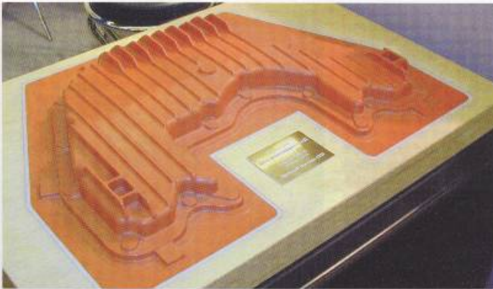
Ce moule de carter d'huile d'un modèle sport BMW série M destiné à la fabrication d'une petite série a été usiné dans un nouveau matériau importé par la société Codim.
