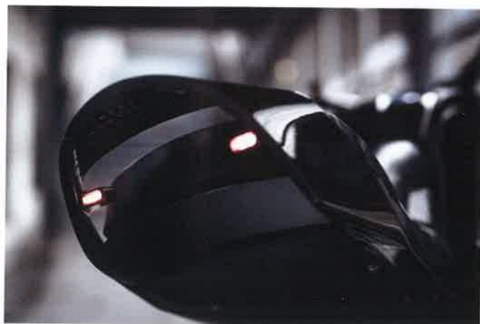
La selle dossier en deux parties est elle aussi issue d'une impression 3 D. Moule 3 D pour l'assise en silicone, polyamide pour le support et boucle arrière de soutien, en acier.
